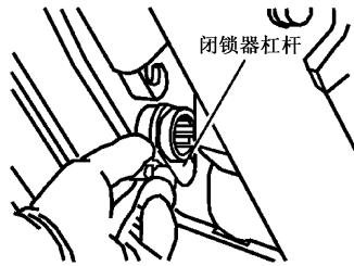
图 65 将闭锁器杠杆放在炮尾的孔内
