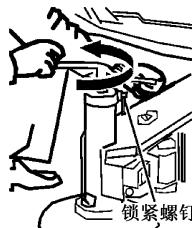
图 10 转动杠起螺杆,使履板收到最上方
