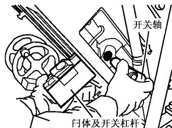
图44 向外抽出开关轴,再取下闩体和开关杠杆
