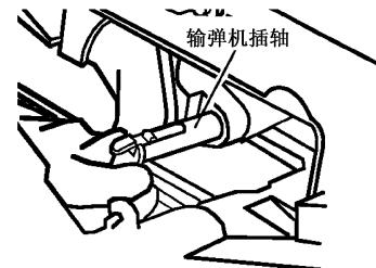
图 79 抽出输弹机插轴
