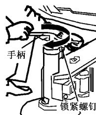
图 26 转动杠起螺杆手柄使四个车轮离地
