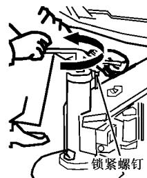
图 137 转杠起螺杆使四个车轮着地
