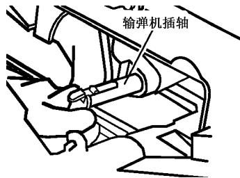
图 103 插入输弹机插轴
