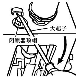
图 71 用 12 吋起子压下闭锁器顶帽
