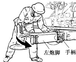
图 9 扳开手柄打开左炮脚
