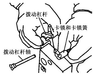
图 55 取出拨动杠杆、击发卡锁和弹簧
