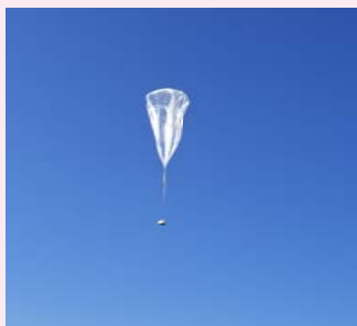
原位采样温室气体廓线观测探空气球平台
